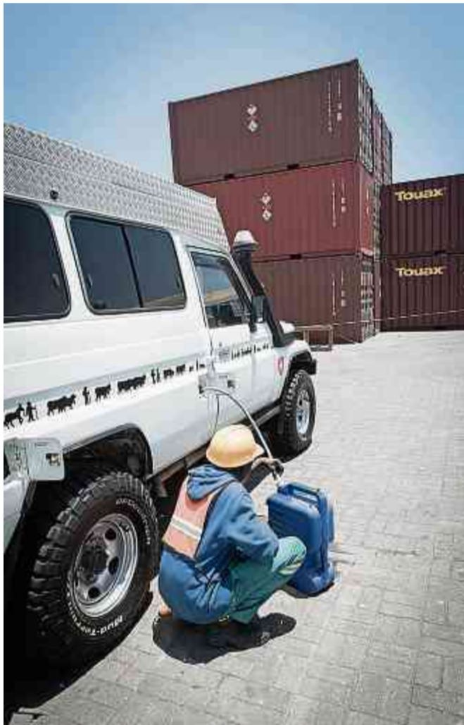
Noch kurz den restlichen Diesel ablassen und rein in den Container.
